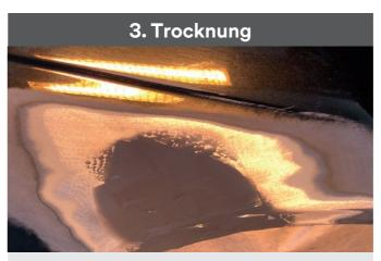
Forcierte Trocknung von 15–20 Minuten bei 70 °C Objekttemperatur.
