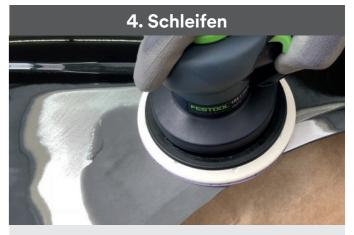
Für eine glatte Oberfläche, schleifen Sie bitte mit 3M™ Cubitron™ II 80+ (51369) bis 120+ (51370). Folgen Sie im Weiteren die Schritte im Schleifprozess.
