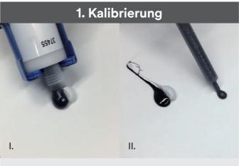
Bitte verwenden Sie ausschließlich gleichmäßiges graues und durchmischtes Material.
