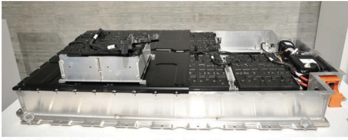
Die Li-Io-Batterie des i3 besteht aus acht Modulen mit insgesamt 96 Zellen. Bei Batterieproblemen kann die Werkstatt einzelne Module tauschen. Der Akku ist auf eine Lebensdauer von zehn Jahren beziehungsweise 150.000 km und etwa 1000 Ladezyklen ausgelegt. Bildquelle: BMW
