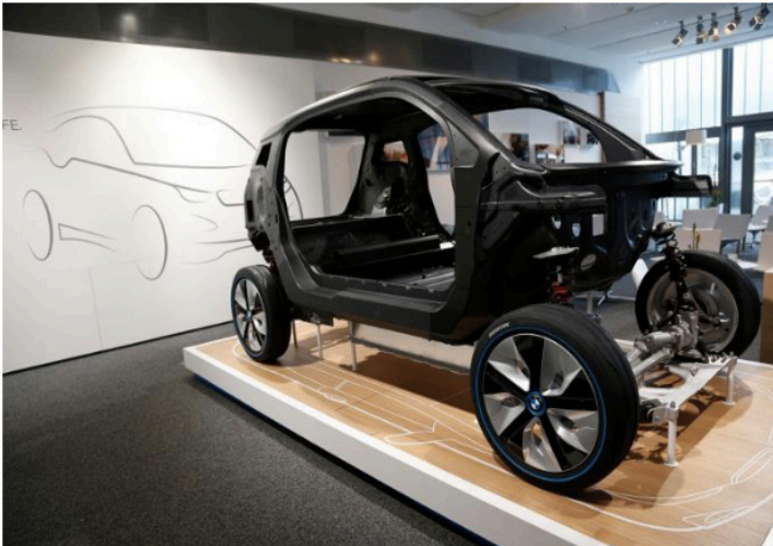
Die Carbon-Karosserie des BMW i3 sitzt auf einem Aluminiumrahmen, der die Fahrwerks- und Antriebskomponenten sowie den Hochvolt-Speicher aufnimmt. Bildquelle: TS
