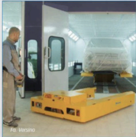
Mit dem Transmobil von Herkules-Lift lassen sich E-Fahrzeuge ohne Rekuperationsgefahr in der Werkstatt bewegen. Bildquelle: Herkules Hebetchnik
