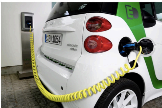
Per Wallbox lassen sich E- und Hybrid-Fahrzeuge deutlich schneller laden als über die herkömmliche Steckdose. Bildquelle: Daimler AG
