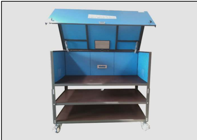
Bild 2: verschließbarer Arbeitsplatz für Arbeiten an HV-Akkus |Quelle: Gelkoh Bild 3: HV-Akku-Quarantänebox |Quelle: Gelkoh
