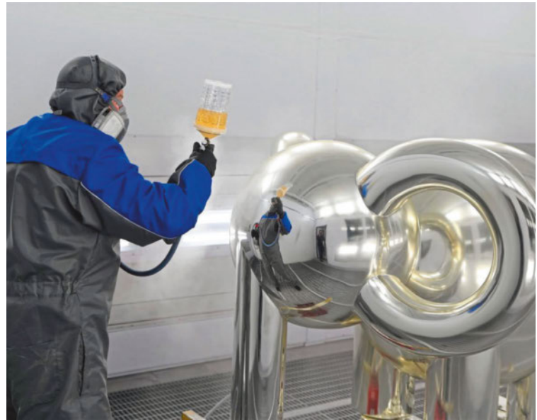
Der Lackierer trägt den Klarlack auf. Die Oberfläche des „Philifanten“ erscheint zunächst trüb-gelb.
