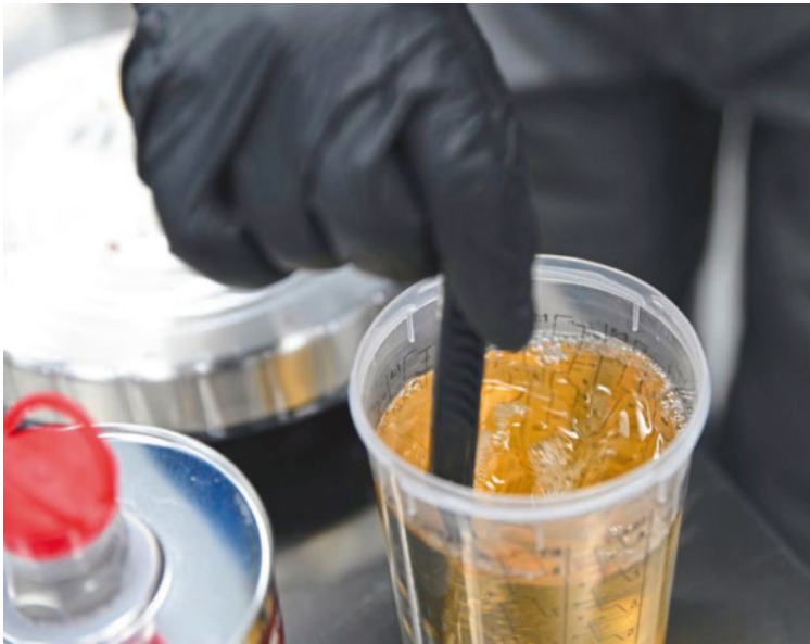
Damit die verspiegelte Oberfläche geschützt bleibt, kommt ein Klarlack mit UV-Absorbern darauf. Dieser wirkt zunächst gelblich.
