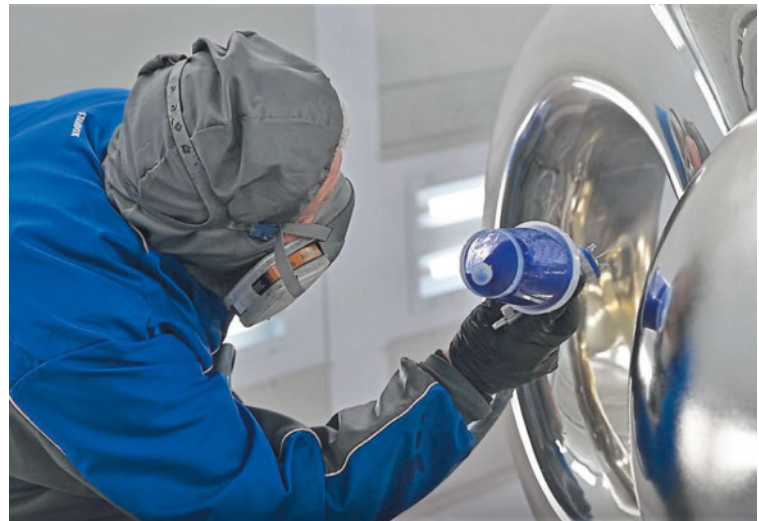
Farbenmagie: Durch den violett-eingefärbten zweiten Klarlackgang erhält das Kunstobjekt seinen klaren Spiegelglanz zurück.
